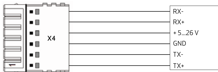
Fig. 9: Pinbelegung Stecker X4 und externe Schnittstelle
