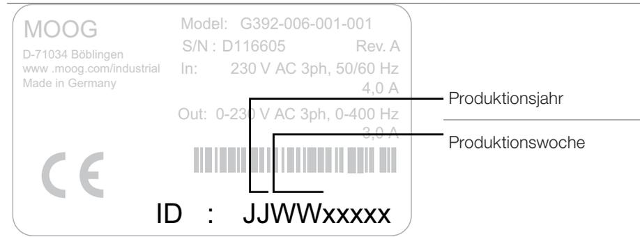
Bild 1.2 Typenschild Hardware MSD Servo Drive
