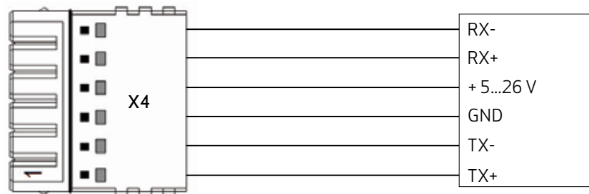
Fig. 9: Pinbelegung Stecker X4 und externe Schnittstelle
