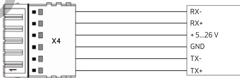
Fig. 9: Pinbelegung Stecker X4 und externe Schnittstelle
