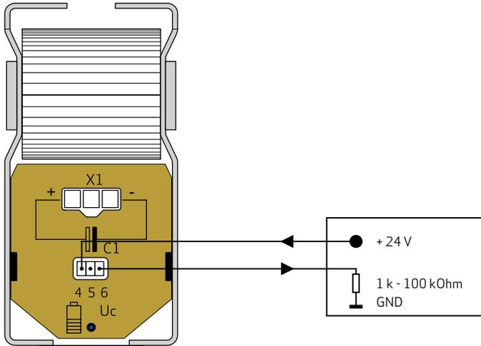
Fig. 10: Überwachungsschnittstelle, Gehäuseoberseite
