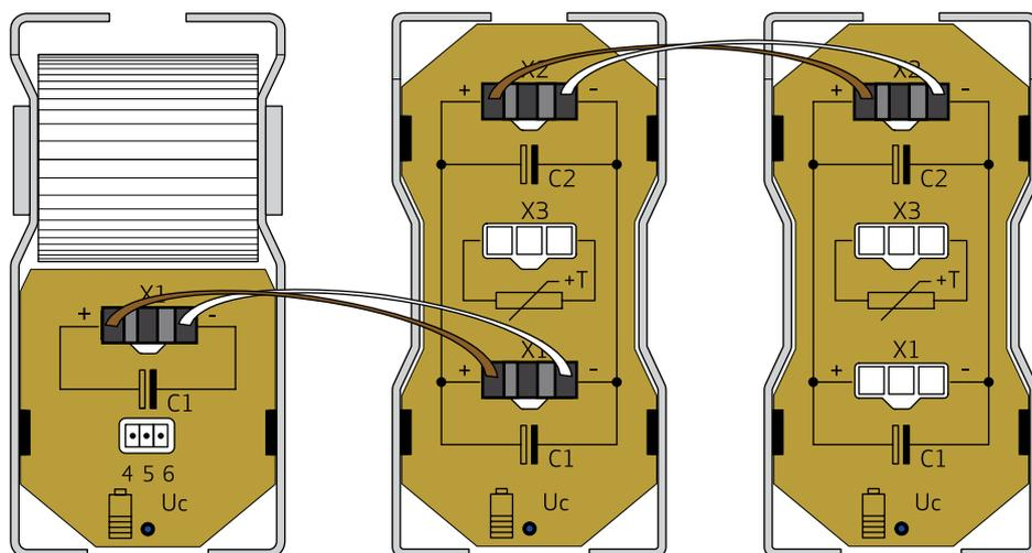
Fig. 19: DEU-SU und zwei Erweiterungsmodule verbinden
