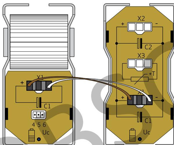
Fig. 16: DEU-SU und Erweiterungsmodul verbinden (Gehäuseoberseite)
