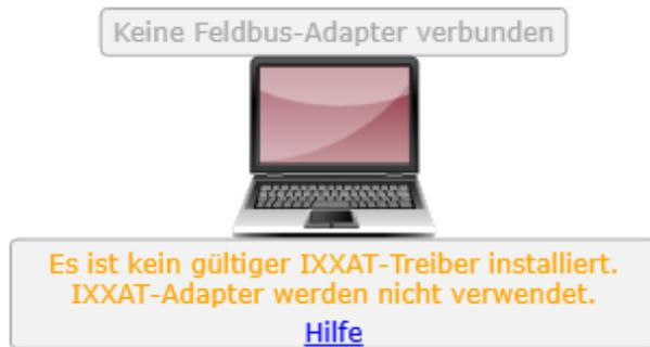
Das ist kein Problem, wenn kein USB-to-CAN Adapter verwendet werden soll, z.B., weil die Verbindung über EtherCAT hergestellt wird.
